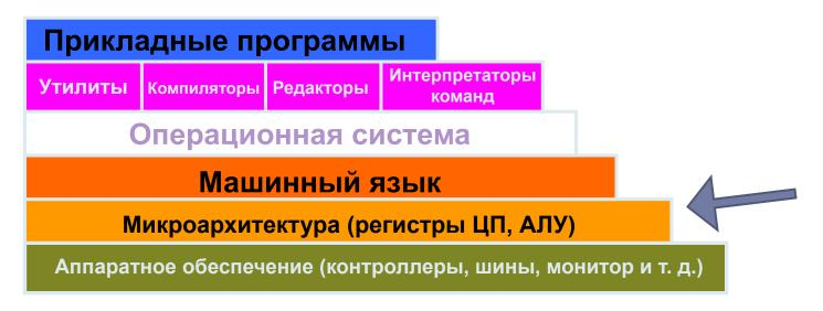
Выше (у некоторых машин) расположен микроархитектурный уровень – примитивная программная прослойка, напрямую работающая с оборудованием и упрощающая интерфейс для программ более высокого уровня. Эта программа, обычно называемая микропрограммой, располагается в ПЗУ.
