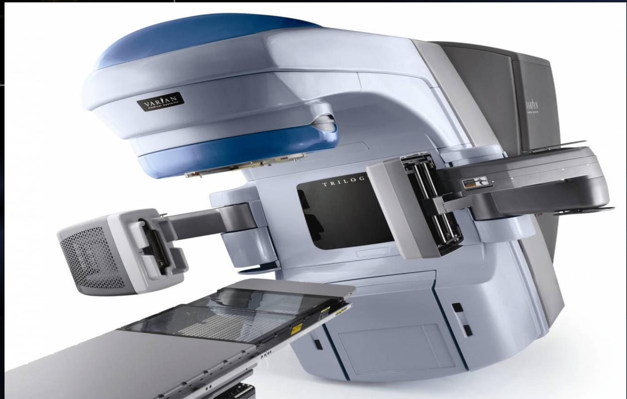
✓ **Аппараты для радиохирургического лечения** осуществляют прицельное облучение малых мишеней с помощью специальных стереотаксических устройств с использованием точных оптических направляющих систем для трехмерной радиотерапии множественными источниками.
