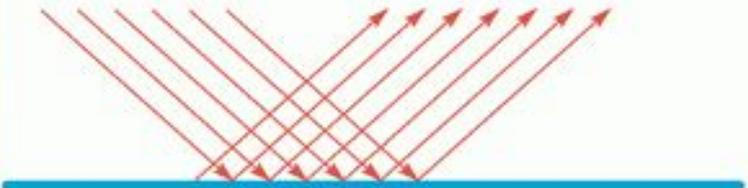
При зеркальном отражении угол падения равен углу отражения
