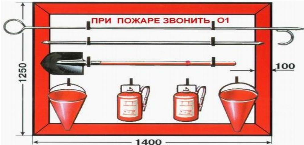
**ПРЕДНАЗНАЧЕН** для размещения первичных средств пожаротушения, немеханизированного инструмента и пожарного инвентаря в производственных и складских помещениях, не оборудованных противопожарным водопроводом и автоматическими установками пожаротушения, а также на территории предприятий, не имеющих наружного противопожарного водопровода, или при удалении зданий (сооружений), наружных технологических установок на расстояние более 100 м от наружных пожарных водоподводников.
