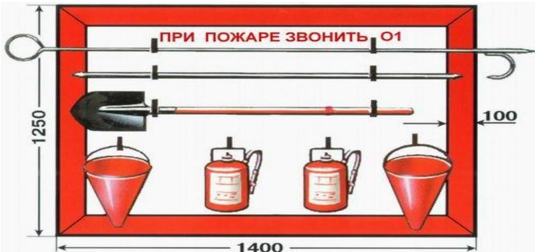
**ПРЕДНАЗНАЧЕН** для размещения первичных средств пожаротушения, немеханизированного инструмента и пожарного инвентаря в производственных и складских помещениях, не оборудованных противопожарным водопроводом и автоматическими установками пожаротушения, а также на территории предприятий, не имеющих наружного противопожарного водопровода, или при удалении зданий (сооружений), наружных технологических установок на расстояние более 100 м от наружных пожарных водосточников.
