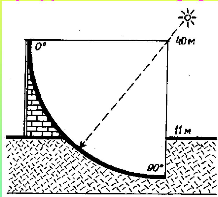
Схема главного инструмента. На крыше здания обсерватории (верхний правый угол) находилось отверстие (диоптр), через которое свет от небесных светил падал на меридианные дуги. Инструмент позволял измерять высоту светил над горизонтом.
