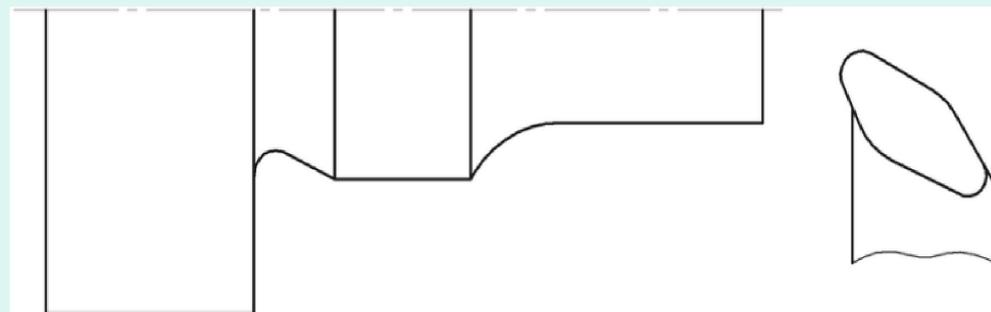
На деталях типа тел вращения, в которых необходимо выполнение канавок для выхода инструмента (шлифовального круга, резьбового резца и т. п.), надо их выполнить с возможностью обработки одним резцом для контурного точения
