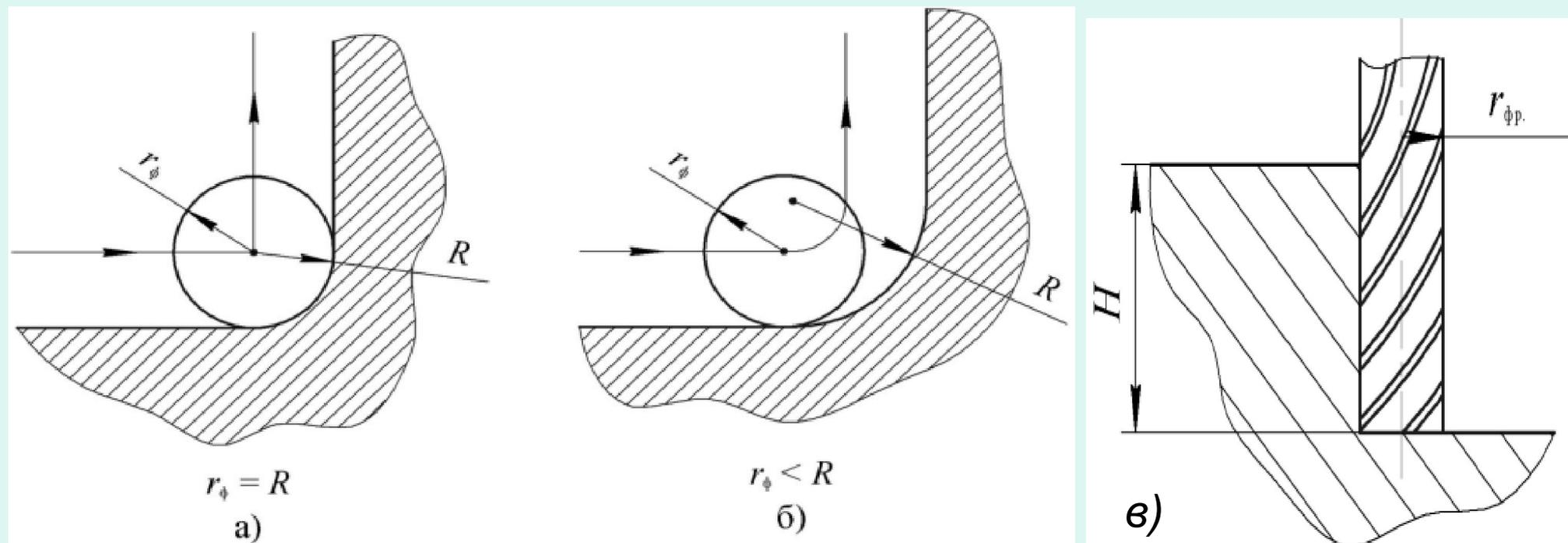
В тех случаях, когда участки с криволинейными поверхностями имеют высокие точности, они должны выполняться методом обхода (рис. б), но инструментами таких диаметров, которые обеспечивают их жесткость при данных условиях обработки (рис. в). Это обязывает назначать радиусы таких размеров, которые позволяли бы выбрать инструмент необходимого диаметра. Нормальный ряд типоразмеров фрез: 5, 6, 7, 8, 9, 10, 11, 12, 14, 16, 18, 20, 22, 25, 30 и т. д.
