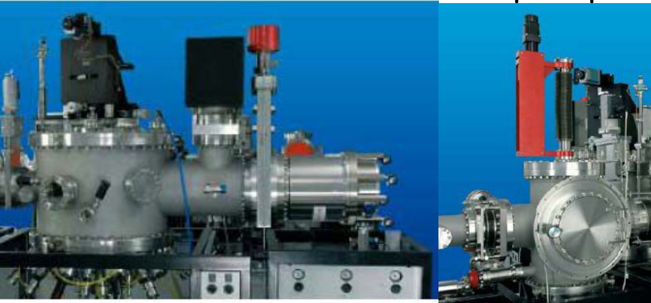
Рис. а - Камера роста МЛЭ установки STE3N3 (Россия). б - Шлюз МЛЭ установки STE3N3
