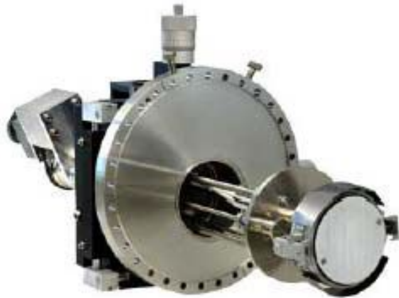
Рис. Манипулятор МЛЭ установки STE3N3 (Россия).
