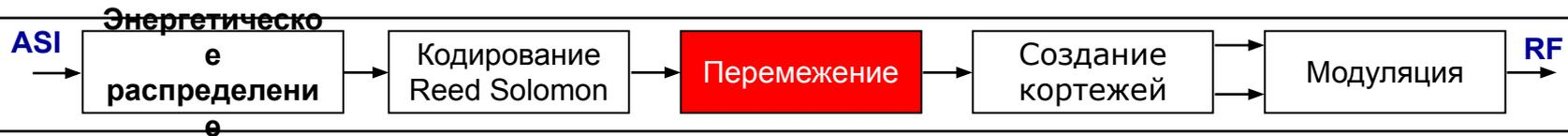
Этот этап имеет предназначен для распределения появляющихся ошибок при трансляции, с целью увеличения возможности кодовой коррекции RS.
