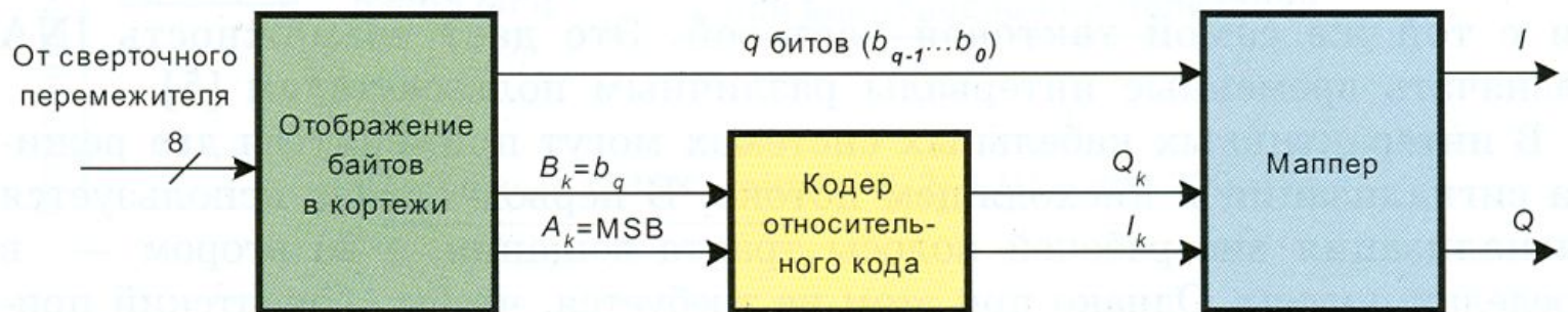
Структурная схема дифференциального кодирования
