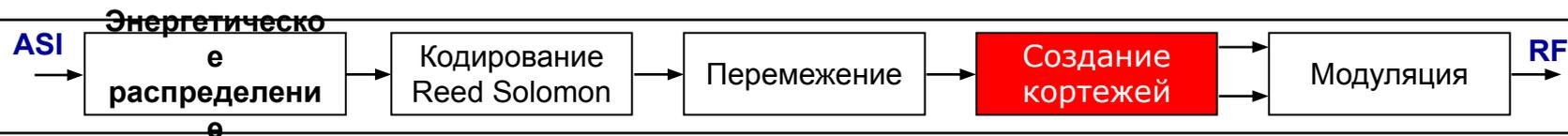
Минимальный цикл преобразования в 1 байт соответствует видам модуляции 16 и 256-QAM. При 256-QAM байты и кортежи совпадают.
