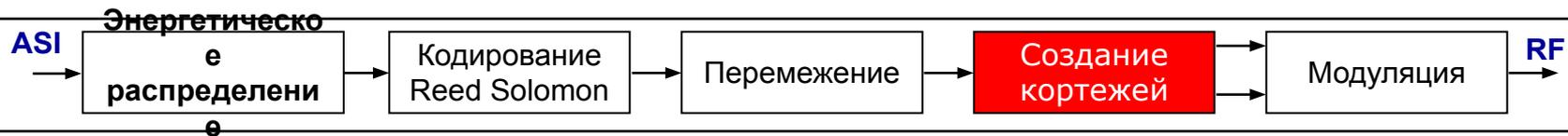
После сверточного перемежения непрерывную последовательность байтов необходимо разделить на короткие последовательности битов, каждая из которых соответствует символу QAM, т.е. определенной точке на квадратурной диаграмме модулированного сигнала. Такие последовательности двоичных символов называются кортежами.
