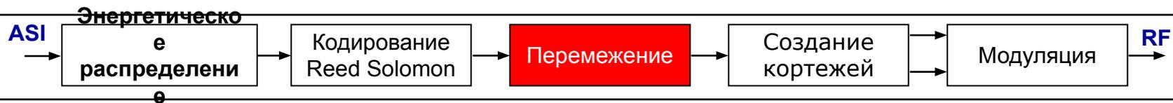
Для борьбы с пакетированием ошибок применяют перемежение (перестановку) символов передаваемой последовательности на передаче и восстановление ее исходной структуры на приеме. Благодаря перемежению на входе декодера ошибки распределяются во времени более равномерно, в идеале преобразуясь в поток независимых ошибок.
