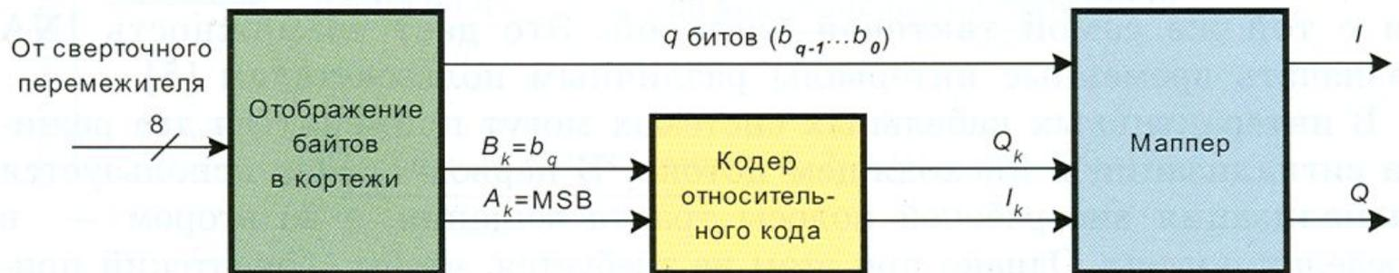
Структурная схема дифференциального кодирования
