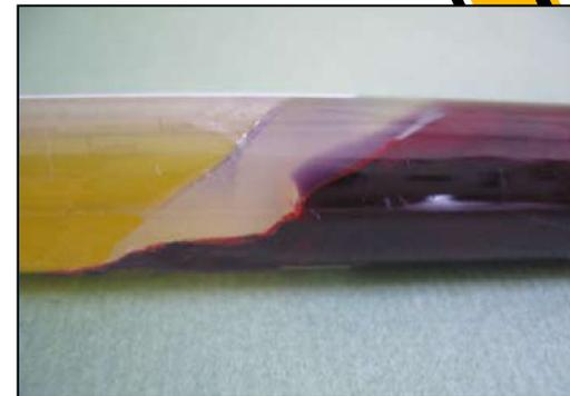
Горизонтальное положение пробирки при транспортировании + угловой ротор
