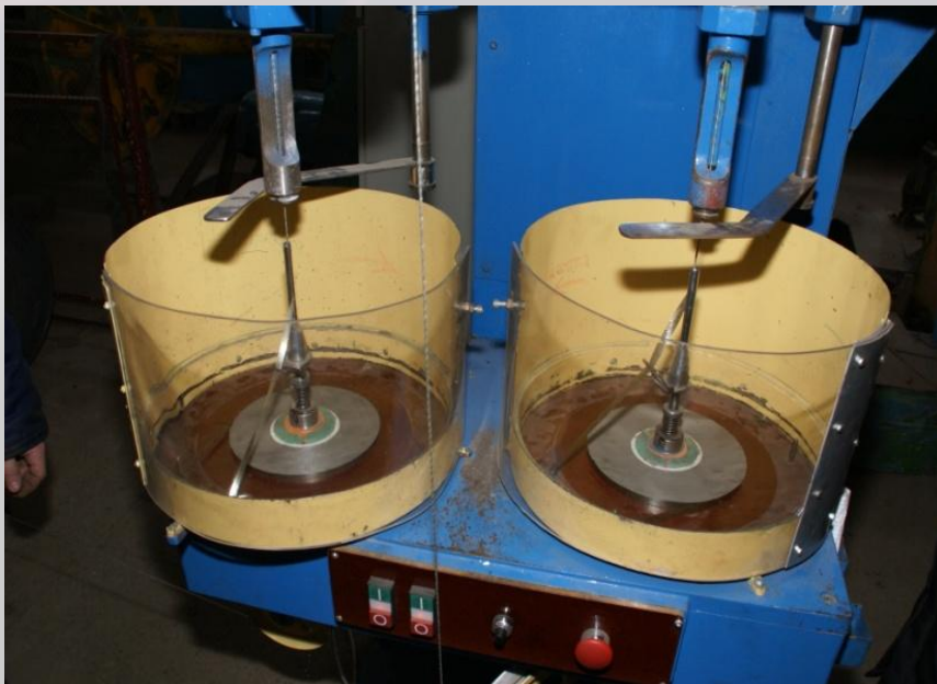
Процесс наложения на жилу стеклослюденитовых лент
