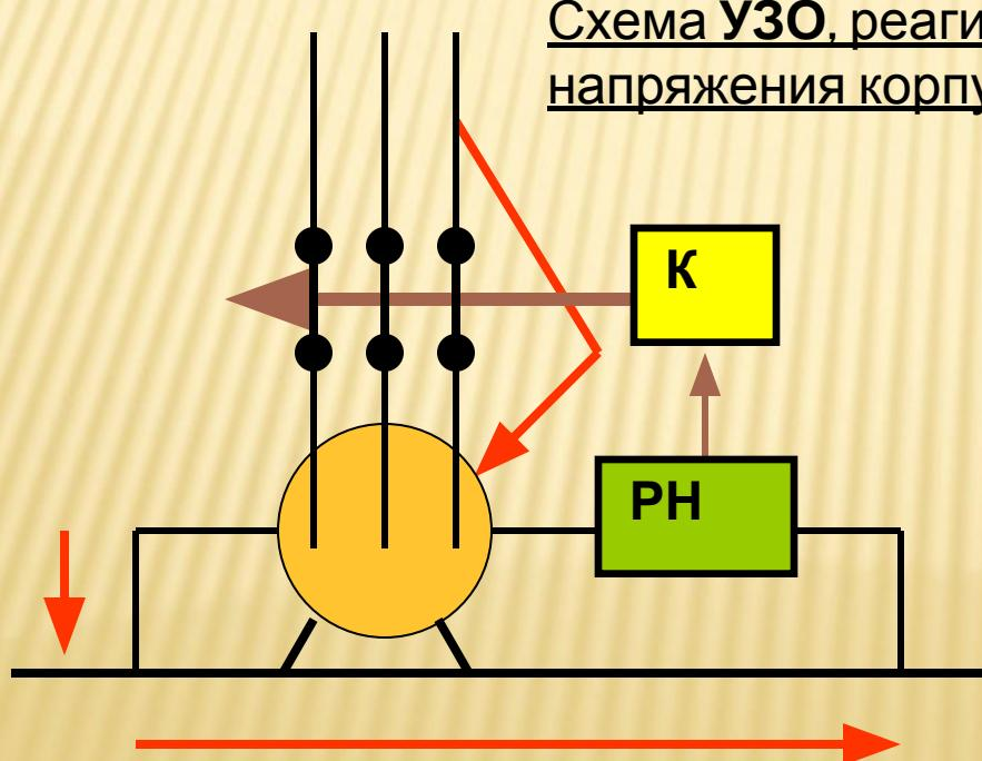
Схема УЗО, реагирующая на изменение напряжения корпуса относительно земли
