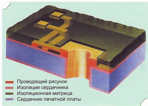
Рис. 12. Конструкция печатной платы по технологии «Прима»
