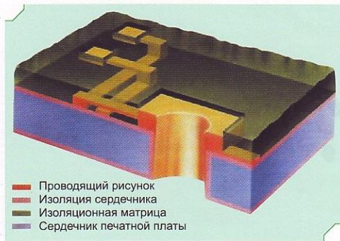
Рис. 12. Конструкция печатной платы по технологии «Прима»
