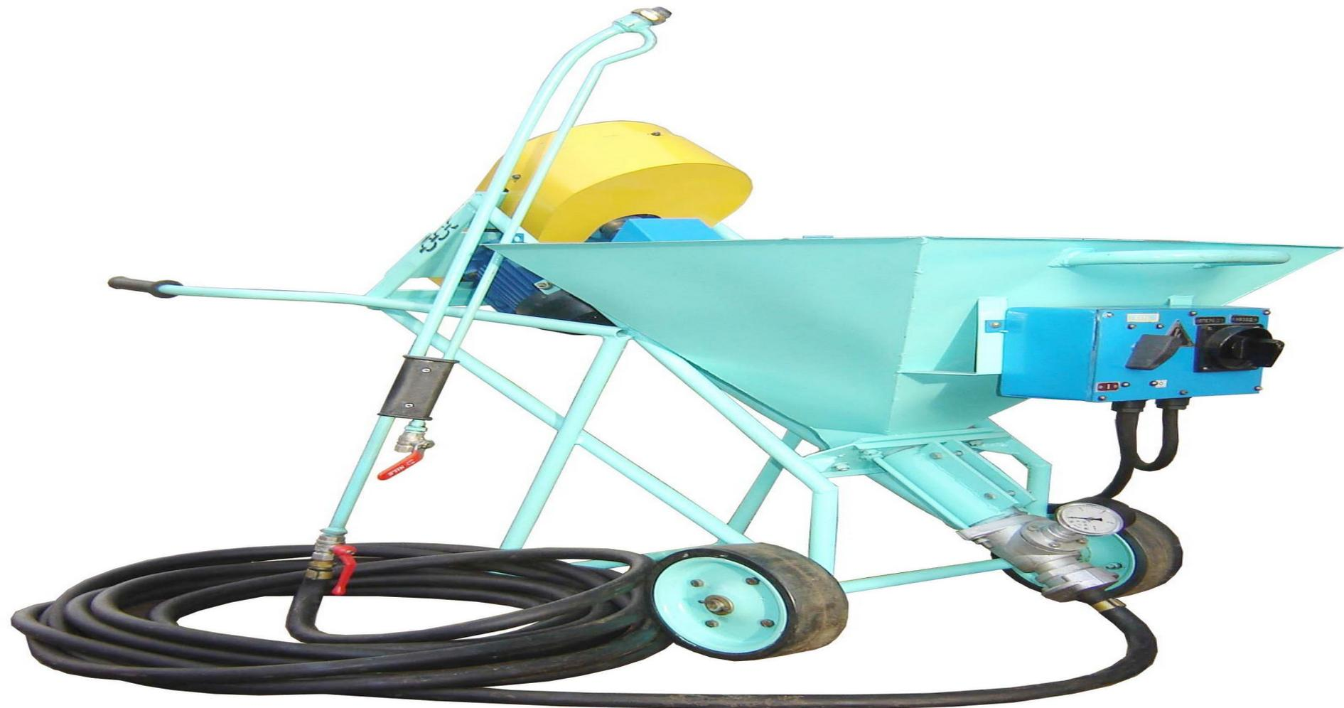
Предназначена для подачи по рукавам и нанесения на поверхности водных малярных составов, в т. ч. известковых и меловых составов повышенной консистенции.
