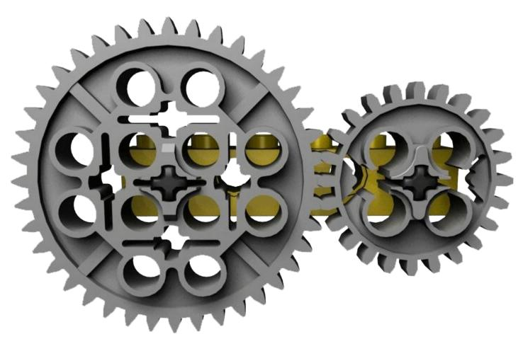
В зубчатой передаче участвуют две или более шестерни. Чтобы передача работала корректно, одна из шестерней должна быть приведена в движение каким-либо двигателем (быть ведущей), а вторая шестерня должна приводиться в движение под действием первой шестерни (быть ведомой).
