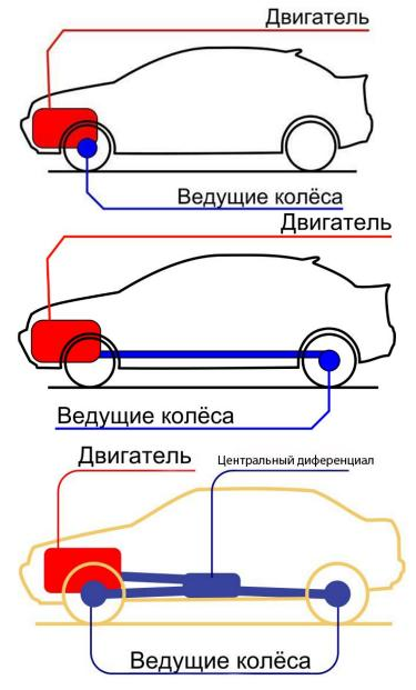
Разобравшись с тем, как вращение доходит от двигателя до колес автомобиля, разберемся с еще одним важным нюансом – приводами автомобилей.
