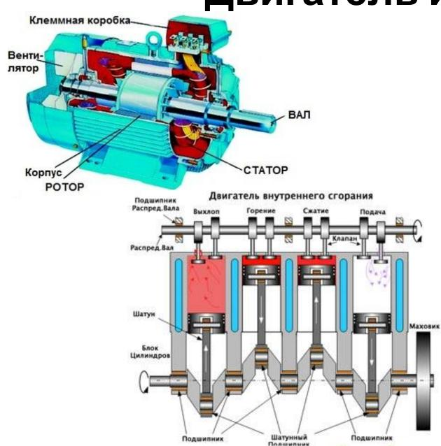
Двигатель – это сердце автомобиля. Будь то бензиновый, газовый двигатель (работающий за счет сгорания в нем воздушно-топливной смеси, приводящей двигатель в движение) или же электродвигатель (работающий за счет вращения вала под действием магнитного поля, создаваемого движением электрического тока по медным проводам), основной сутью является приведение в движение маховика (большой шестерни), вращение с которого передается на колеса автомобила
