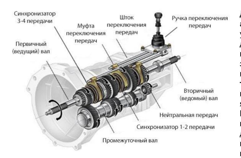
Для того чтобы управлять движением автомобиля в зависимости от разных условий (ровная или ухабистая дорога, асфальтированная или грунтовая, сухая или влажная, заснеженная или чистая), вращение маховика передается к колесам через трансмиссию автомобиля. Одним из важнейших узлов трансмиссии является коробка передач. Коробка передач построена на принципе зубчатой передачи: когда движение передается от одних шестеренок к другим шестеренкам путем зацепления «зубчиков» шестеренок друг за друга.
