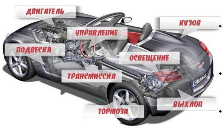
**Кузов** – основной конструкционный элемент автомобиля, на котором размещаются остальные узлы.
