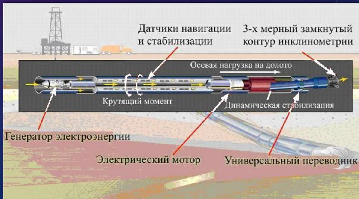
Телесистема типа «Пилот» имеет ряд преимуществ по сравнению с другими типами кабельных телесистем, используемых при бурении направленных скважин:
