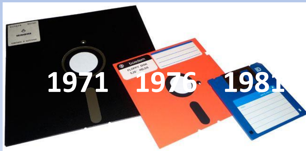
Накопители на гибком магнитном диске (сравнение дискет 8 дюймов, 5,25 дюймов и 3,5 дюйма)
