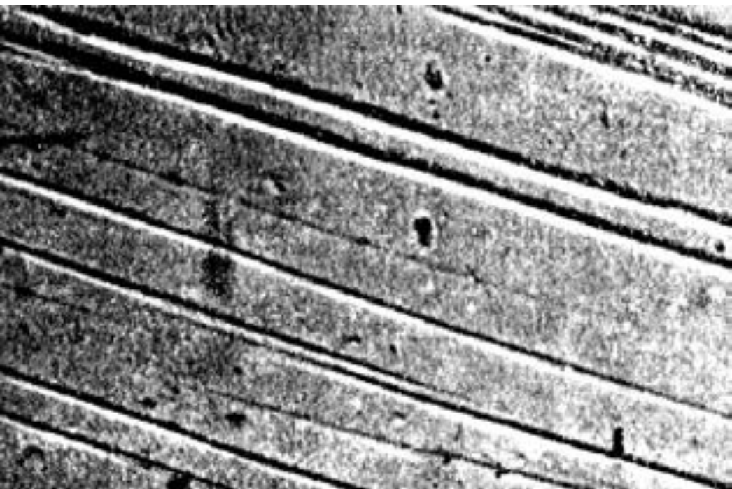
Линии скольжения на полированной поверхности поликристаллического образца деформированного железа x100.
