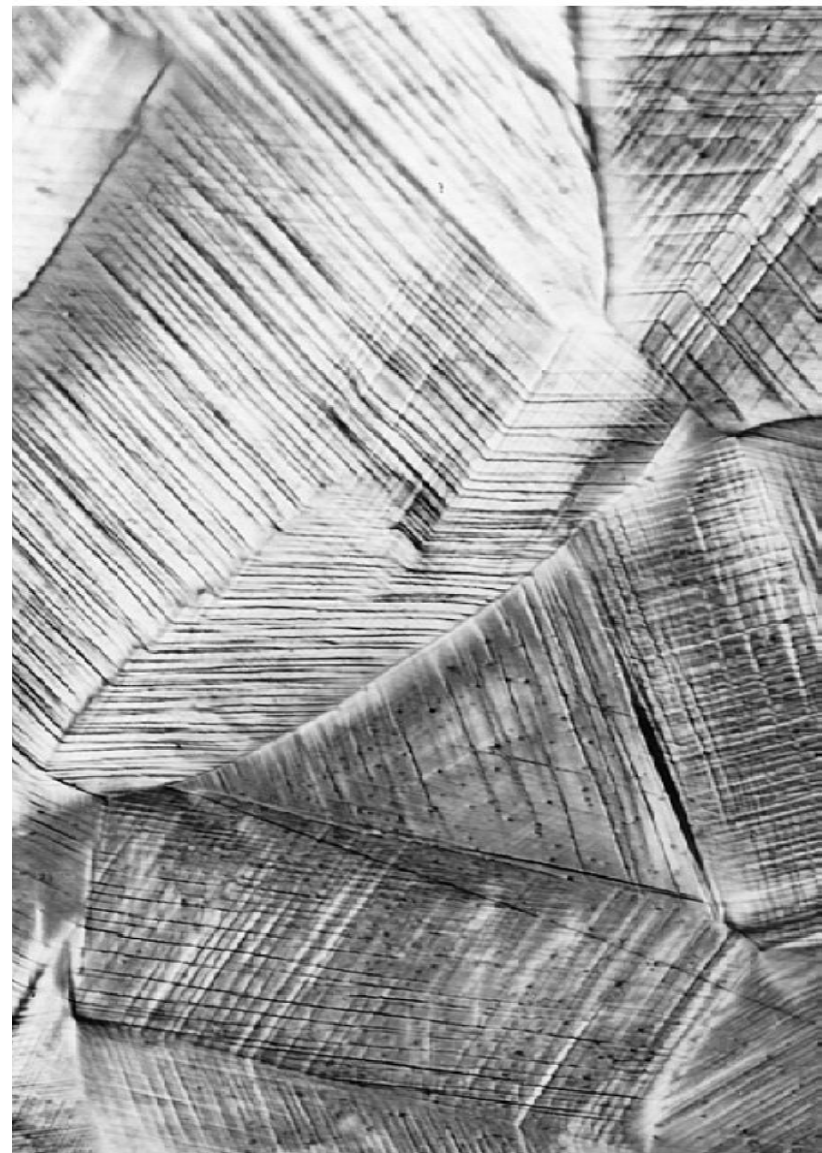
Линии скольжения на поверхности поликристаллического образца меди, которая была отполирована и впоследствии деформирована. x173
