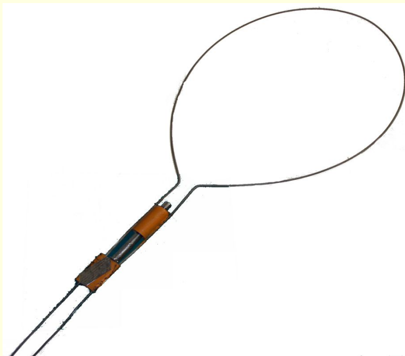
Ручной жезлодержатель, использовался при организации безостановочного пропуска поездов.
