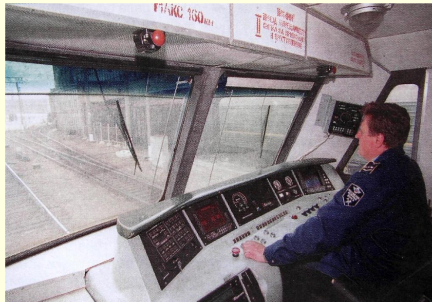
Вид кабины и аппаратуры КЛУБ-У с места машиниста
