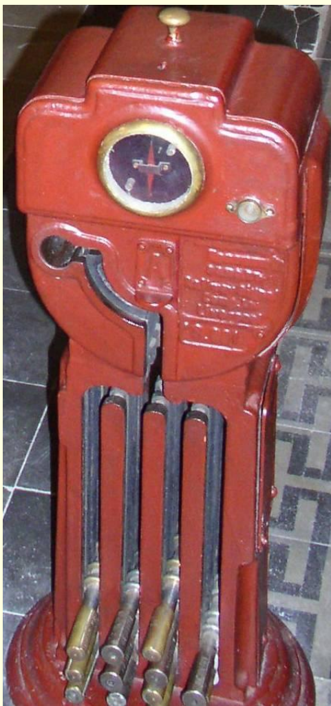
Электромеханический замыкающий жезловый аппарат.
