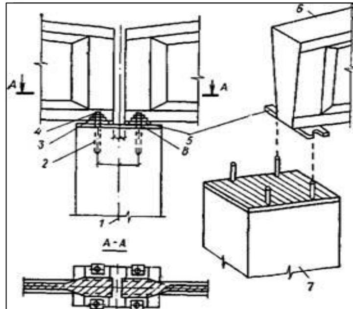
Конструкция соединения ригеля с колонной на анкерных болтах и монтажной сварке
