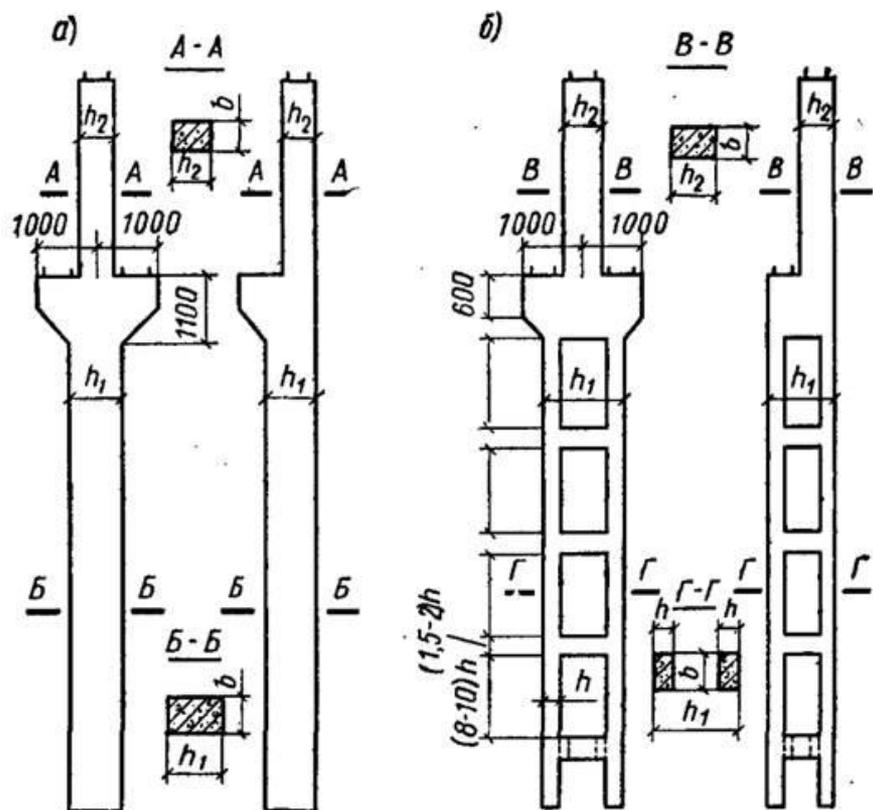
Колонны одноэтажного здания:
