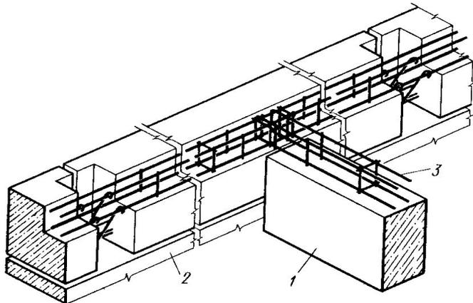
Наружные и внутренние каменные и блочные стены перевязываются арматурными каркасами
