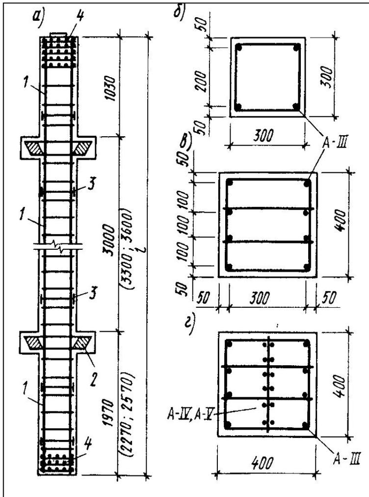
Конструкция колонн здания
