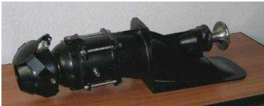
**Схема водометного движителя:**
