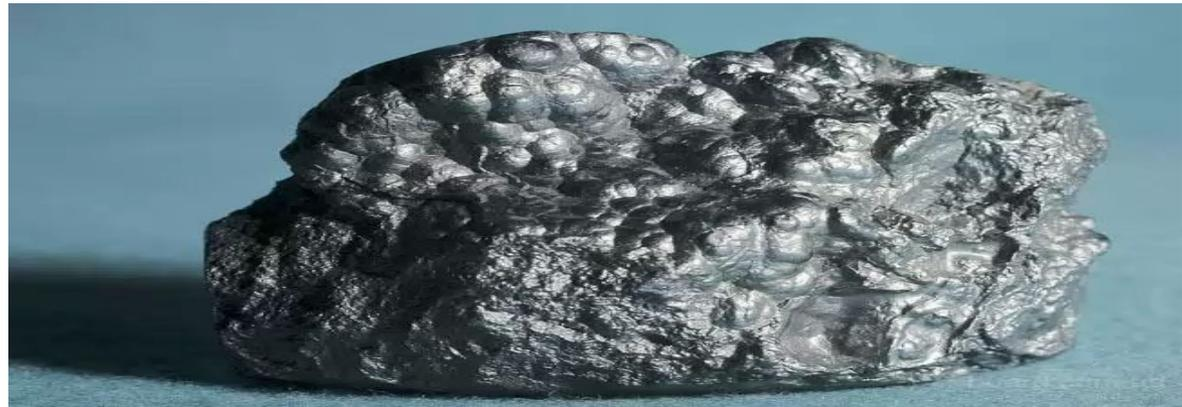
❖ **Цинк** – светло-серый металл с высокими литейными и антикоррозионными свойствами, температура плавления 419 градусов.
