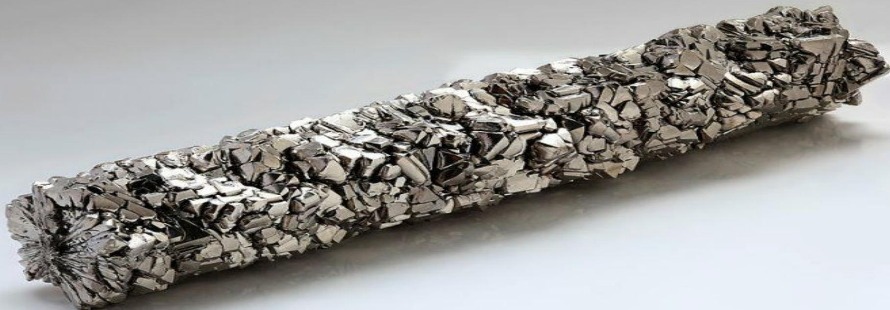
Титан характеризуется высокой коррозионной стойкостью в атмосфере воздуха, в холодной и горячей пресной воде, в щелочных растворах, солях, органических кислотах.
