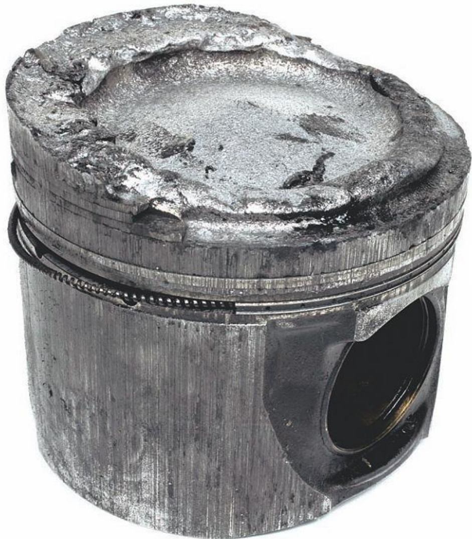
Рис. 2 Расплавленная головка поршня дизельного двигателя
