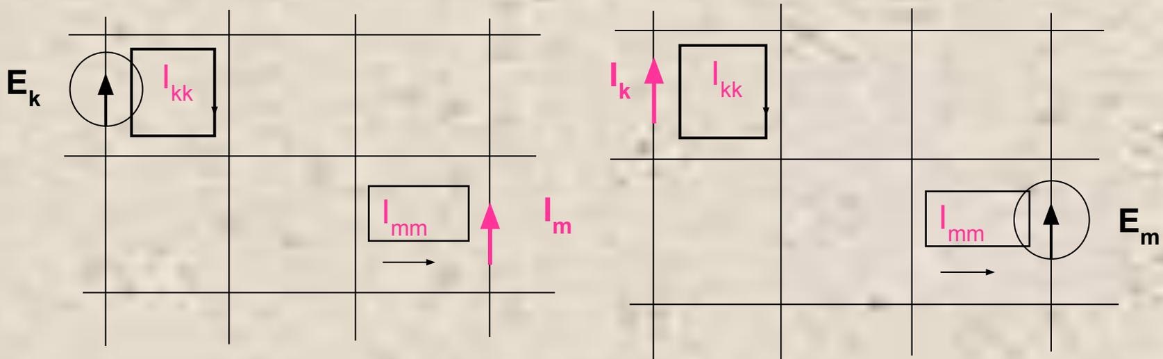
Воспользуемся методом контурных токов. Выберем ветви  $k$  и  $m$  таким образом, чтобы через них протекал только один контурный ток. Тогда получим
