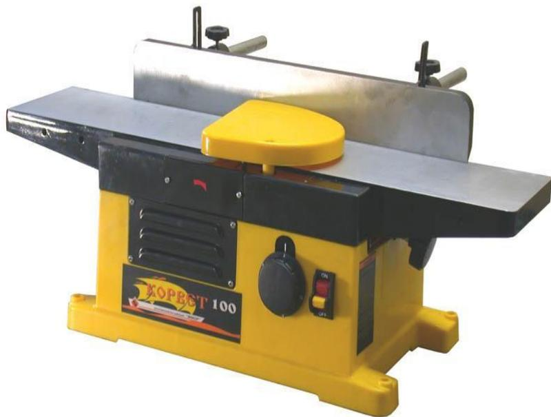
При работе на станке устанавливать передвижные ограждения на всю длину хода стола.
