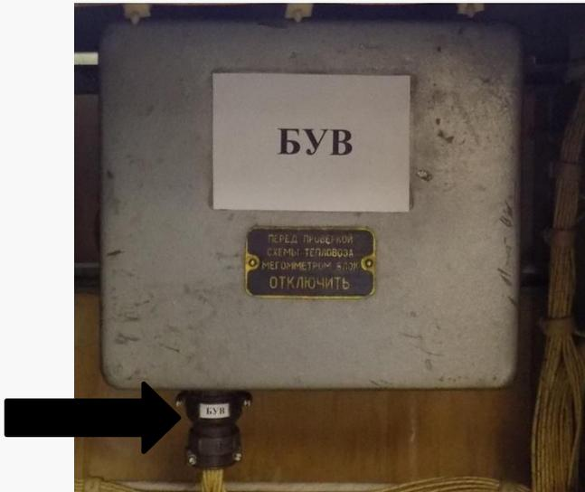
б) резервный блок управления возбуждением
