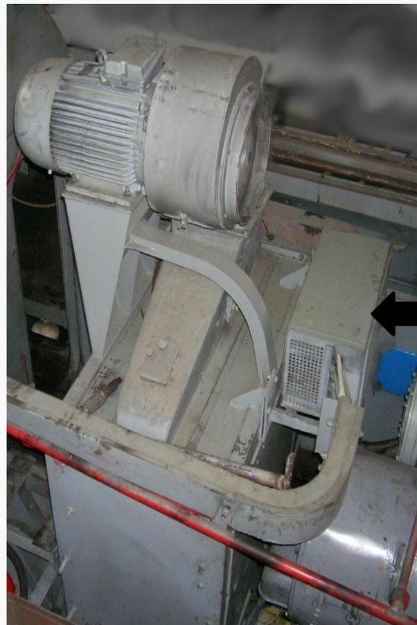
г) контактор возбуждения главного генератора (КВ)- левая ВВК
