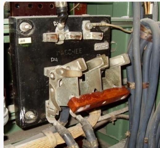
При приеме поезда на станцию с остановкой и наличии времени можно попытаться задействовать резервный блок управления возбуждением (БУВ) в правой ВВК. Для этого при обесточенных цепях возбуждения переставить штепсельный разъем на резервный блок. При этом переключатель АП возвращается в рабочее положение. Если нарушение было по причине неисправности блока и нормальное возбуждение восстановилось, следуем далее на нормальном возбуждении.
