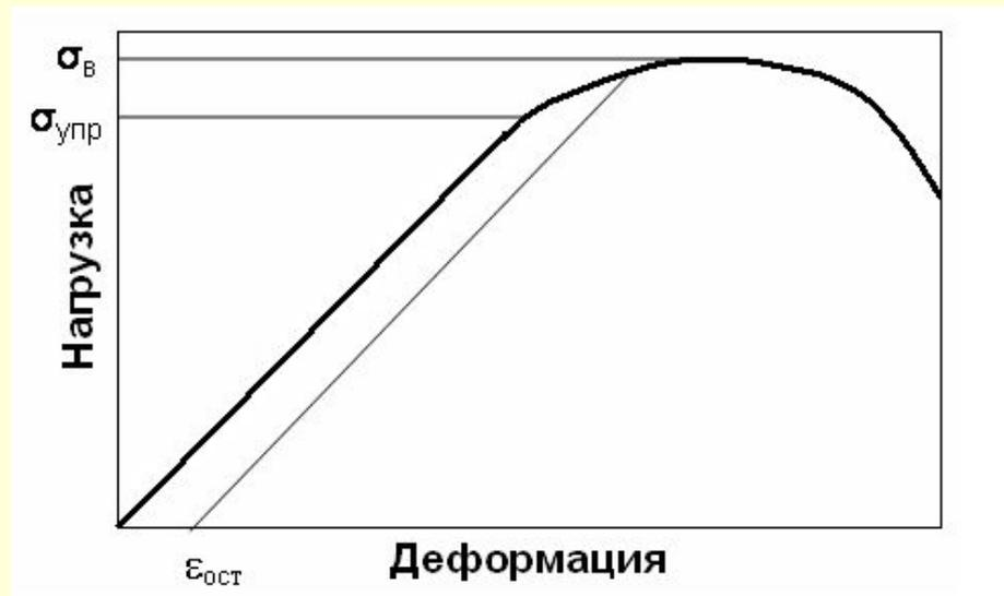
Диаграмма растяжения:  $\sigma_{\text{упр}}$  – предел упругости,  $\sigma_{\text{в}}$  – предел прочности (временное сопротивление разрыву),  $\epsilon_{\text{ост}}$  – остаточная пластическая деформация.
