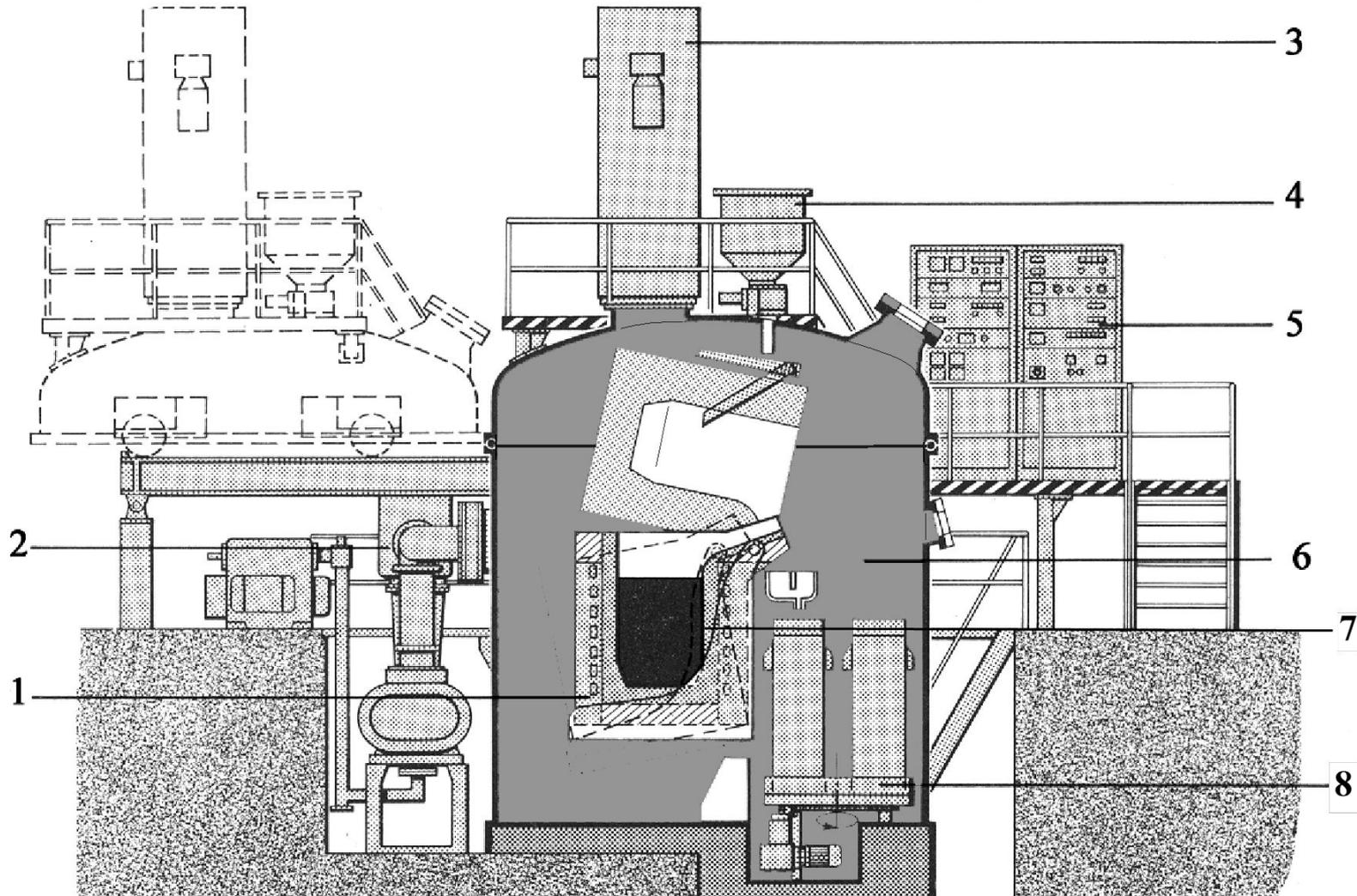
1 – индуктор, 2 – вакуумная система, 3 – камера загрузки, 4 – дозатор для введения присадок, 5 – пульт управления, 6 – плавильная камера, 7 – футерованный тигель, 8 – тележка с изложницами
