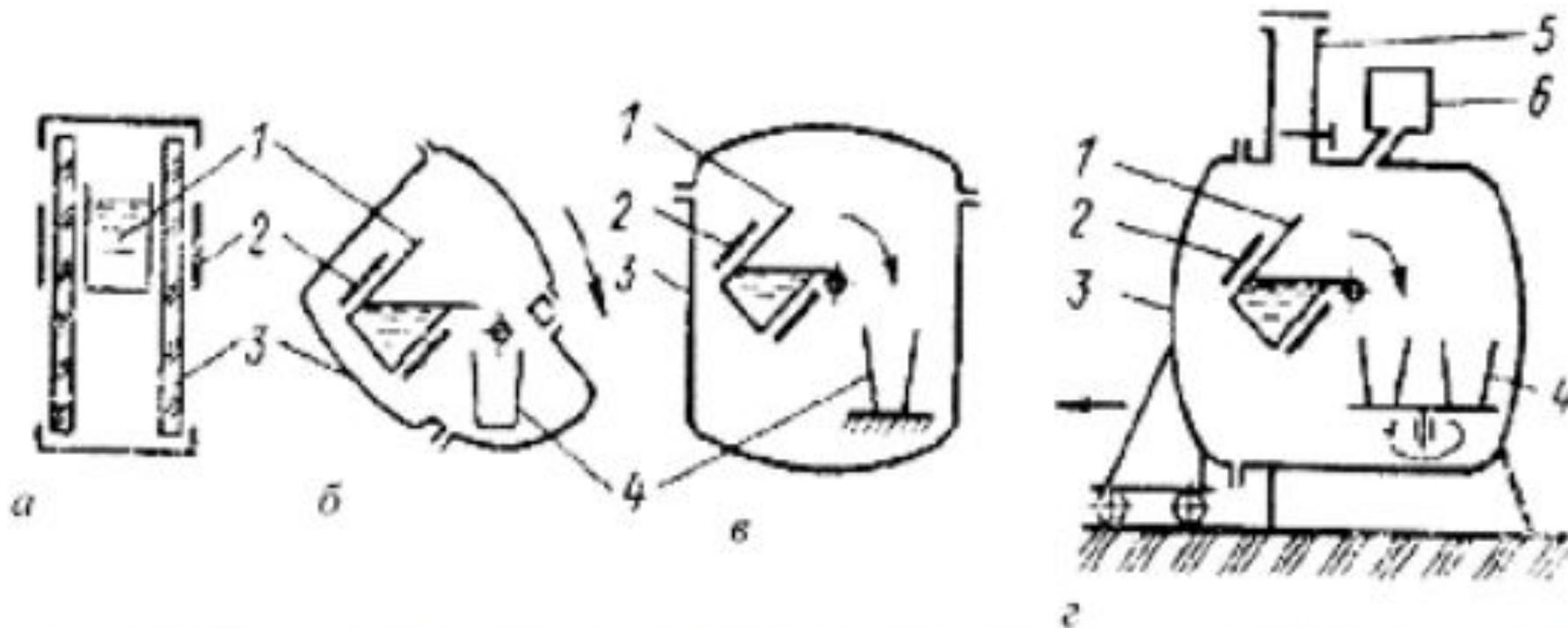
*а* - индуктор расположен вне вакуумной камеры; *б-г* - индуктор расположен внутри вакуумной камеры; *в* - разливка путем наклона вакуумной камеры; *в, г* - разливка путем наклона тигля; *г* - ВИП полунепрерывного действия; 1 - тигель; 2 - индуктор; 3 - кожух; 4 - изложница; 5 - камера загрузки; 6 - дозатор
