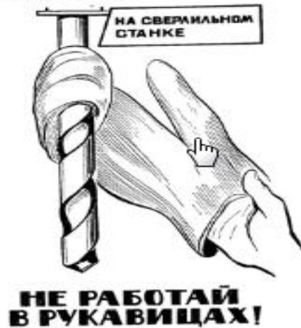
Рис. 2.5. На сверлильном станке не работай в рукавицах
