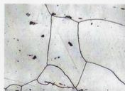
Микроструктура стали 37X12N8Г8МФБ
