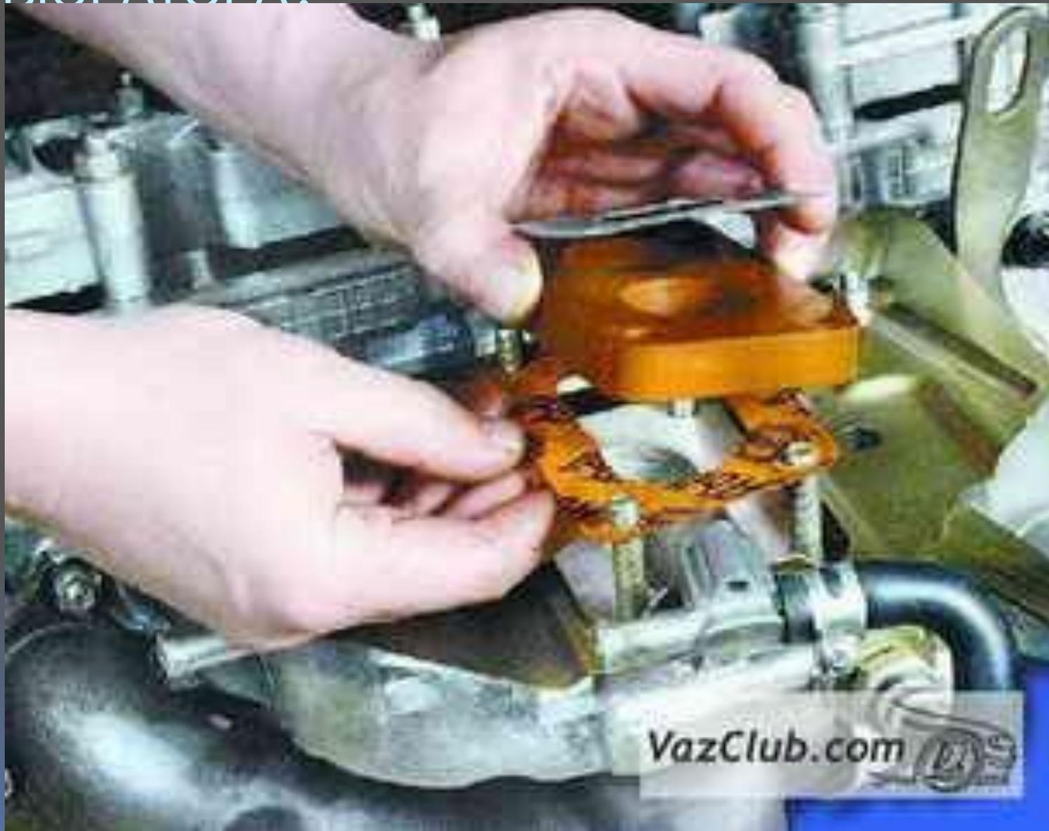
36. УСТАНОВИТЕ КАРБЮРАТОР НА ШПИЛЬКИ И ЗАВЕРНИТЕ ЧЕТЫРЕ ГАЙКИ ЕГО КРЕПЛЕНИЯ МОМЕНТОМ 13-16 Н·М (1,3-1,6 КГС·М)
