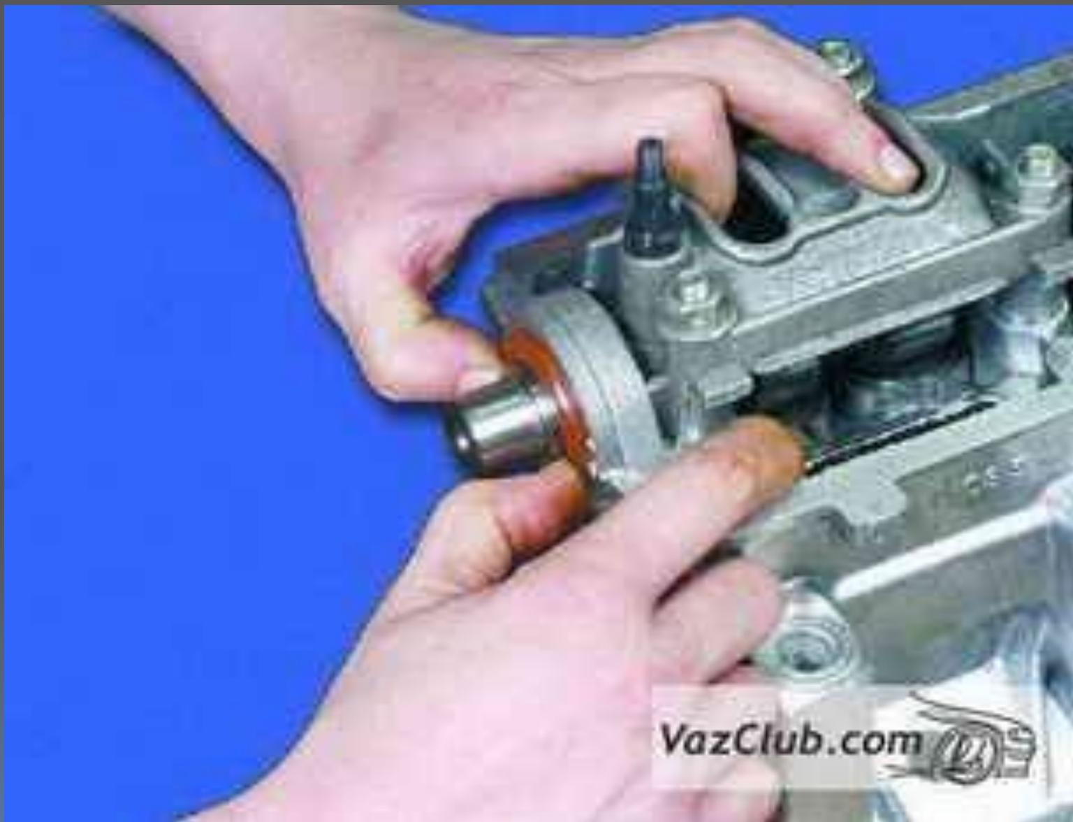
22. УСТАНОВИТЕ НА ШПИЛЬКУ НАТЯЖНОЙ РОЛИК И НАВЕРНИТЕ ГАЙКУ КРЕПЛЕНИЯ, НЕ
