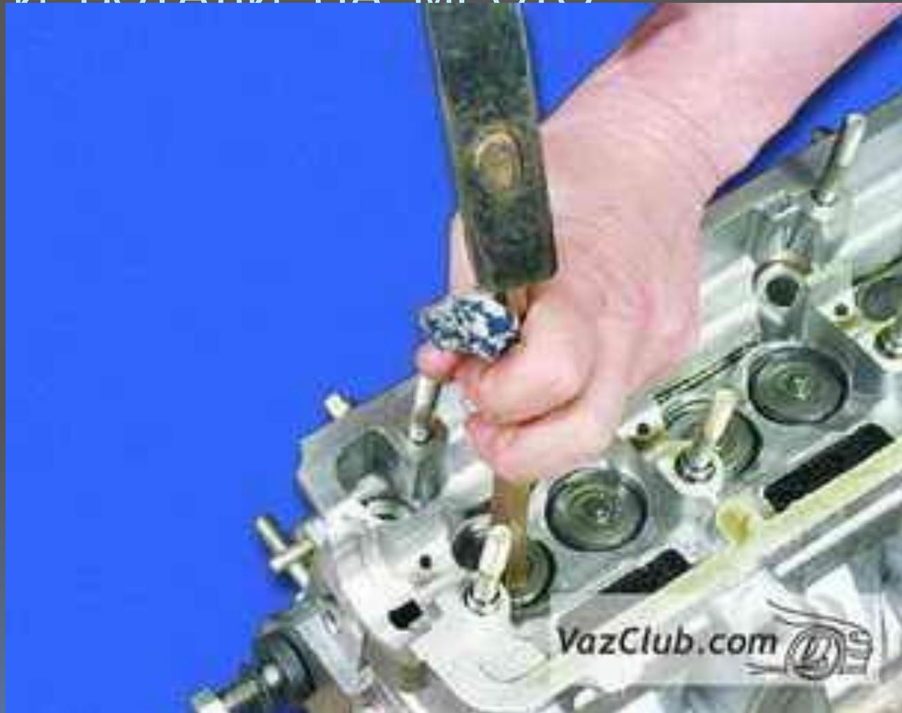
11. ВСТАВЬТЕ РЕГУЛИРОВОЧНЫЕ ШАЙБЫ В ТОЛКАТЕЛИ В СООТВЕТСТВИИ С МЕТКАМИ, СДЕЛАННЫМИ ПРИ РАЗБОРКЕ. ШАЙБЫ ВСТАВЛЯЮТСЯ В ТОЛКАТЕЛЬ ТОЙ СТОРОНОЙ, ГДЕ ВЫГРАВИРОВАНО ЗНАЧЕНИЕ ТОЛЩИНЫ ШАЙБЫ.
