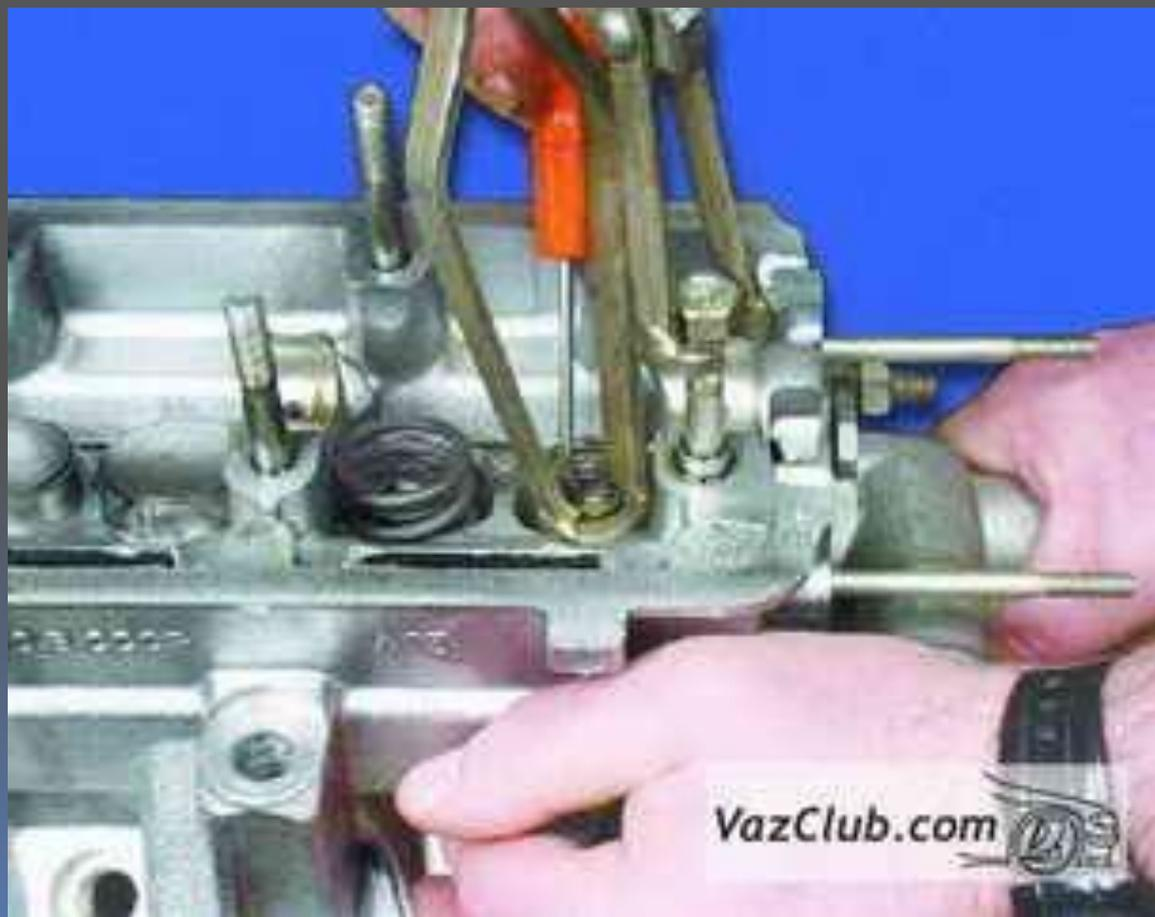
10. ПРОСТУЧИТЕ МОЛОТКОМ ЧЕРЕЗ МЕТАЛЛИЧЕСКИЙ СТЕРЖЕНЬ ПО ТОРЦАМ СТЕРЖНЕЙ КАЖДОГО ИЗ КЛАПАНОВ, ЧТОБЫ СУХАРИ ВСТАЛИ НА МЕСТО
