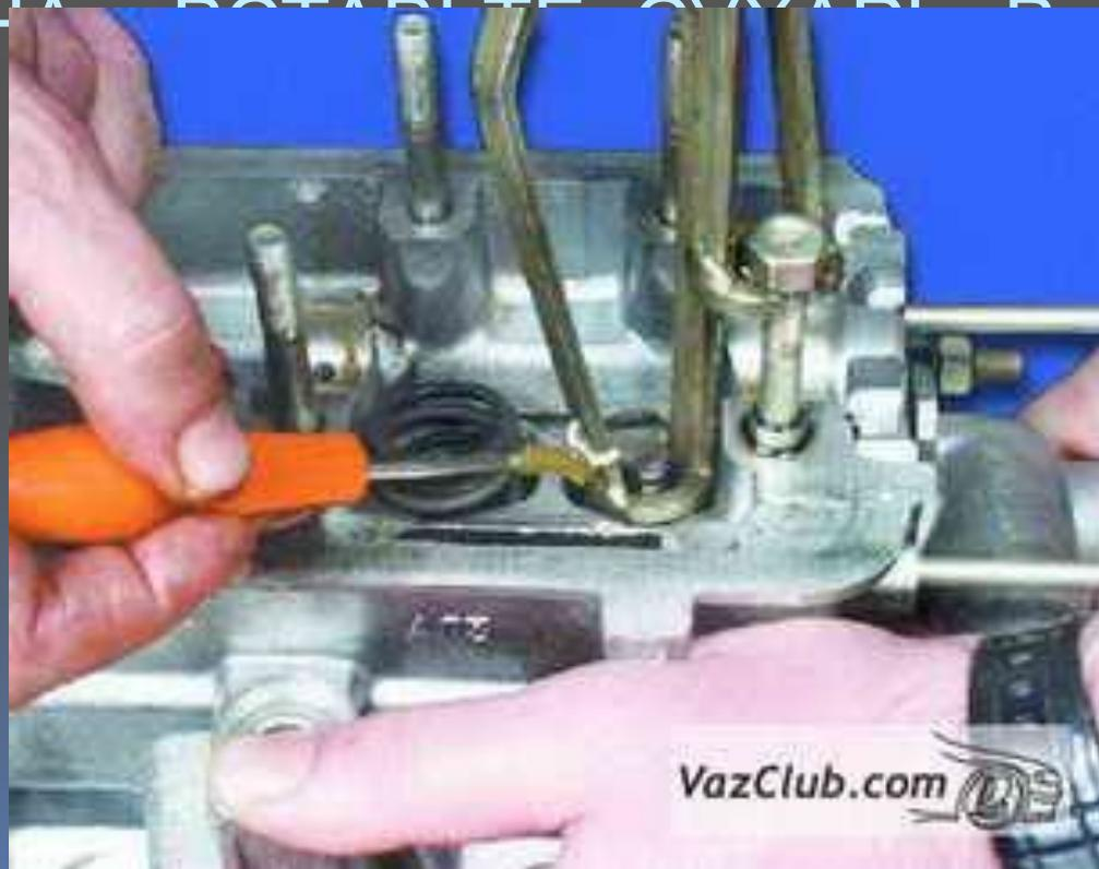
9. ТАКИМ ЖЕ ОБРАЗОМ ВСТАВЬТЕ ВТОРОЙ СУХАРЬ И, ПОСТЕПЕННО ОСЛАБЛЯЯ НАЖИМ НА РУЧКУ ПРИСПОСОБЛЕНИЯ, РАЗОЖМИТЕ КЛАПАННЫЕ ПРУЖИНЫ, ЧТОБЫ СУХАРИ ВОШЛИ В ОТВЕРСТИЕ ТАРЕЛКИ ПРУЖИН КЛАПАНОВ. СНИМИТЕ ПРИСПОСОБЛЕНИЕ. АНАЛОГИЧНЫМ ОБРАЗОМ ЗАМЕНИТЕ ОСТАВШИЕСЯ КЛАПАНЫ.
