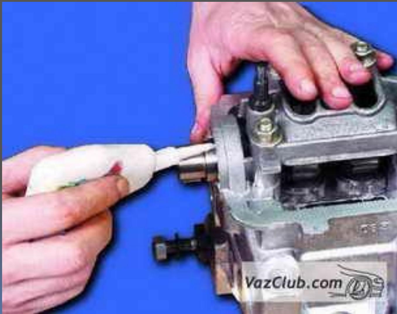
20. САЛЬНИК РАСПРЕДЕЛИТЕЛЬНОГО ВАЛА УСТАНАВЛИВАЕТСЯ С ПОМОЩЬЮ СПЕЦИАЛЬНОЙ ОПРАВКИ. ПРИ ОТСУТСТВИИ ОПРАВКИ НАДЕНЬТЕ САЛЬНИК НА РАСПРЕДЕЛИТЕЛЬНЫЙ ВАЛ ДО ПОСАДОЧНОГО МЕСТА НА ВАЛУ. ЗАТЕМ ЗАОСТРЕННОЙ ПАЛОЧКОЙ ИЗ МЯГКОГО ДЕРЕВА АККУРАТНО ЗАПРАВЬТЕ РАБОЧУЮ КРОМКУ САЛЬНИКА
