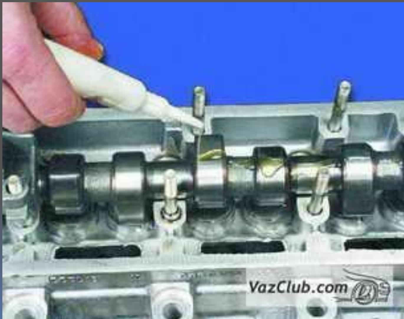
16. НАНЕСИТЕ ТОНКИЙ СЛОЙ ГЕРМЕТИКА НА ПОВЕРХНОСТЬ ГОЛОВКИ, СОПРЯГАЮЩЕЙСЯ С КОРПУСАМИ ПОДШИПНИКОВ В ЗОНЕ КРАЙНИХ ОПОР РАСПРЕДВАЛА
