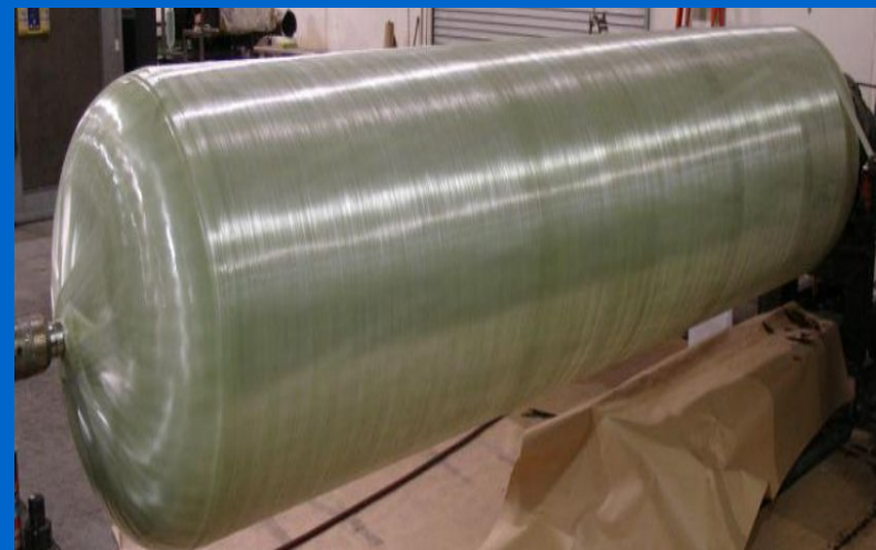
Стальной баллон CNG с стеклопластиковой обмоткой
