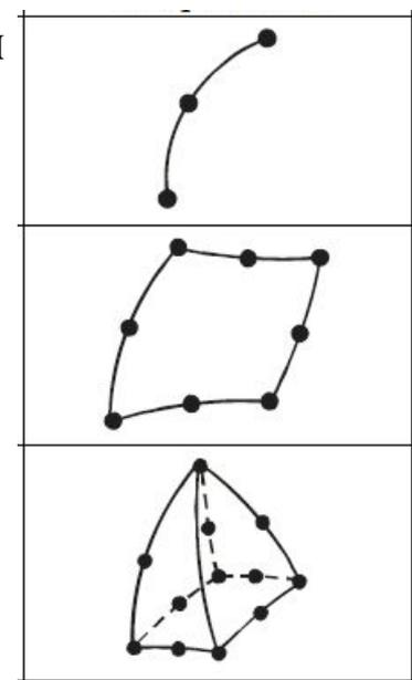
**Первый этап:** построение сетки – аппроксимация исходной области набором простых по форме подобластей (конечных элементов (КЭ)). Замена не точна. КЭ связаны друг с другом в некоторых точках, расположенных на их границах – узлах КЭ. Основными неизвестными считаются перемещения этих точек (узлов).
