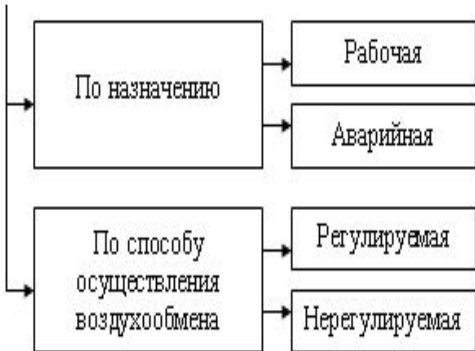
**Естественная вентиляция** создается без применения электрооборудования (вентиляторов, электродвигателей) и происходит вследствие естественных факторов – разности температур воздуха, изменения давления в зависимости от высоты, ветрового давления.
