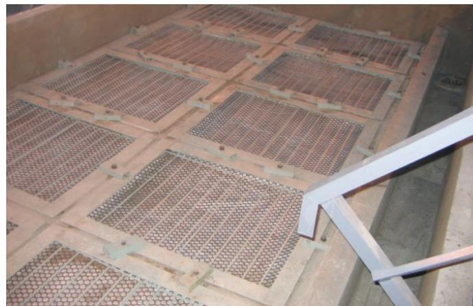
ячейки с установленным фильтрующим материалом
