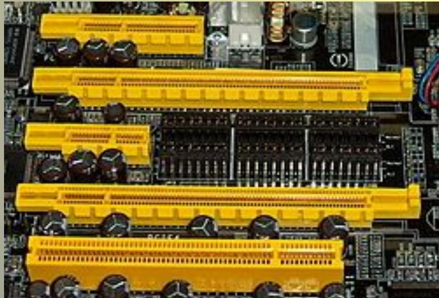
Разъёмы шины PCI Express (сверху вниз: x4, x16, x1 и x16). Ниже - обычный 32-битный разъем шины PCI.
