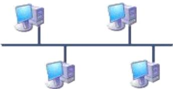
**Топология типа Шина**, представляет собой общий кабель (называемый шина или магистраль), к которому подсоединены все рабочие станции.
