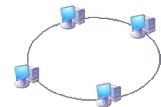
**Кольцо** — базовая топология компьютерной сети, в которой рабочие станции подключены последовательно друг к другу, образуя замкнутую сеть.
