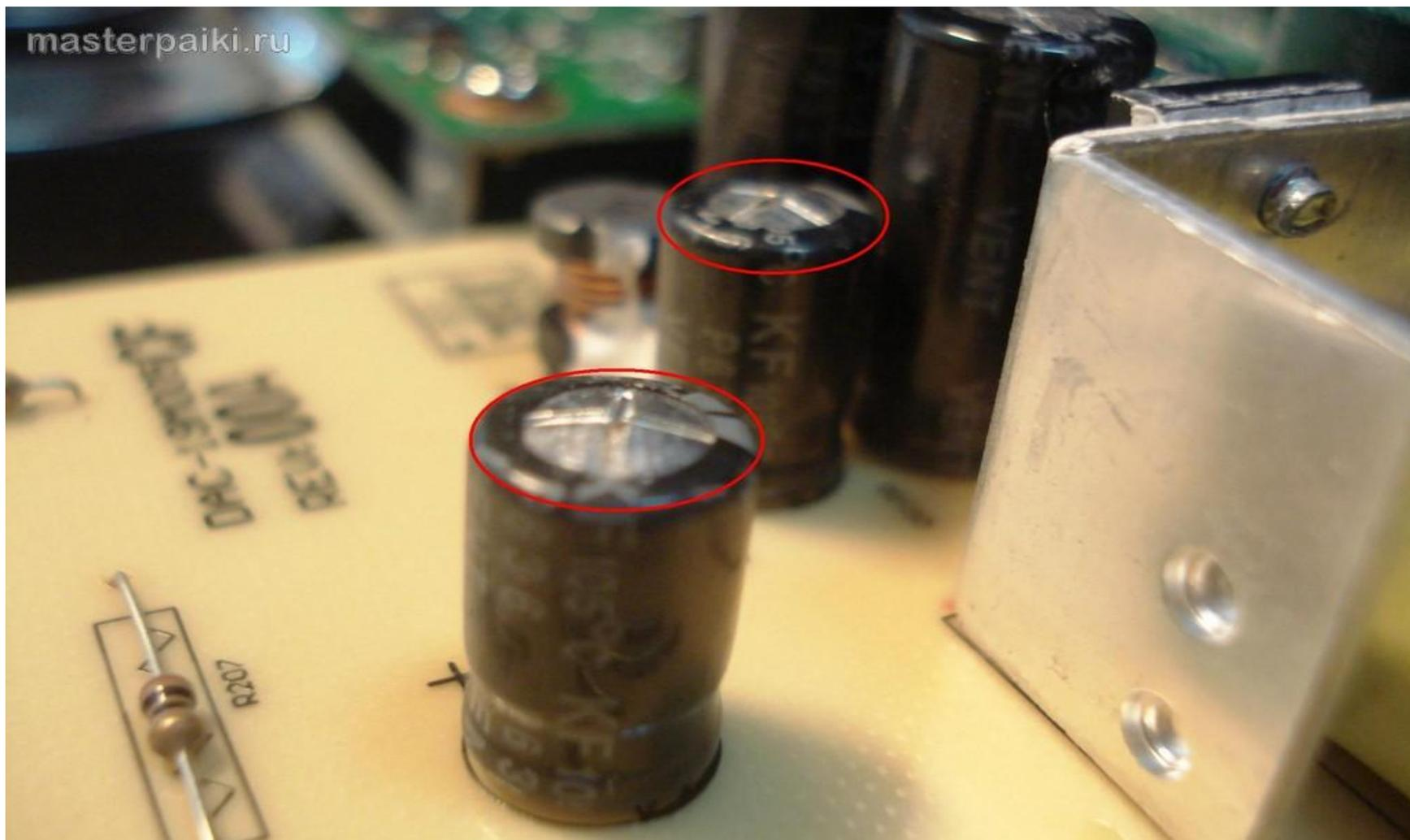
Также проверяем остальные радиоэлементы в следующем порядке – предохранители, конденсаторы, транзисторы, трансформаторы. Ну и конечно же, внимательно осматриваем пайку на предмет микротрещин и холодной пайки.
