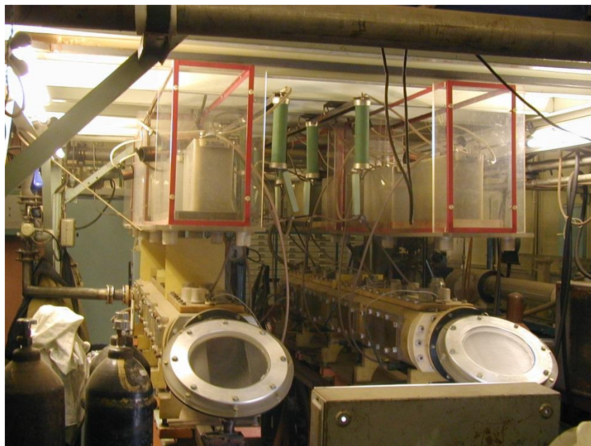
Лазерные кюветы с окнами Брюстера из \text{NaCl} диаметром 300 мм
