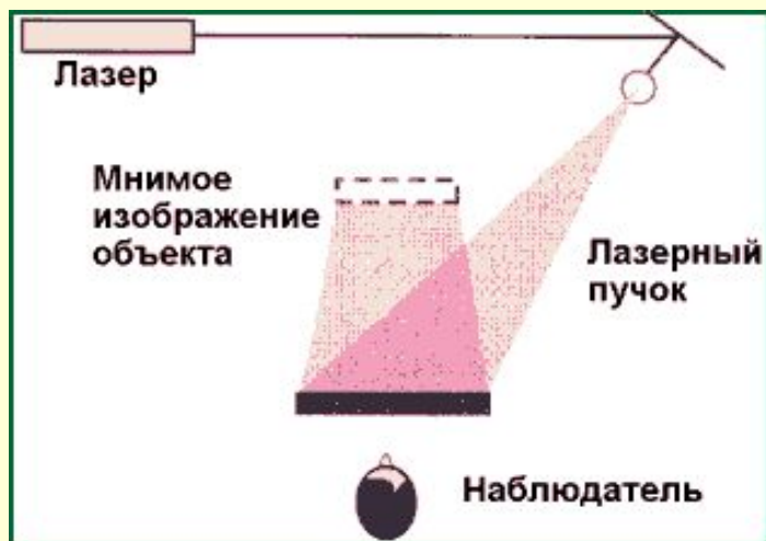
Схема восстановления изображения, записанного на пропускающей голограмме.
