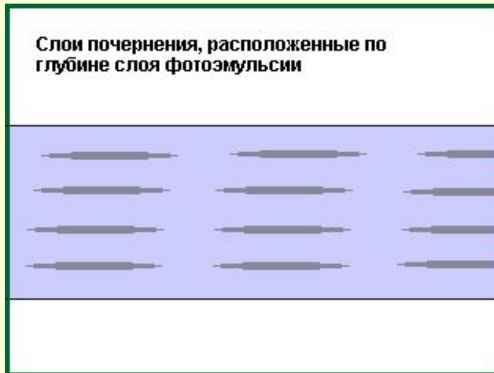
Система плоскостей почернения является встроенным фильтром
