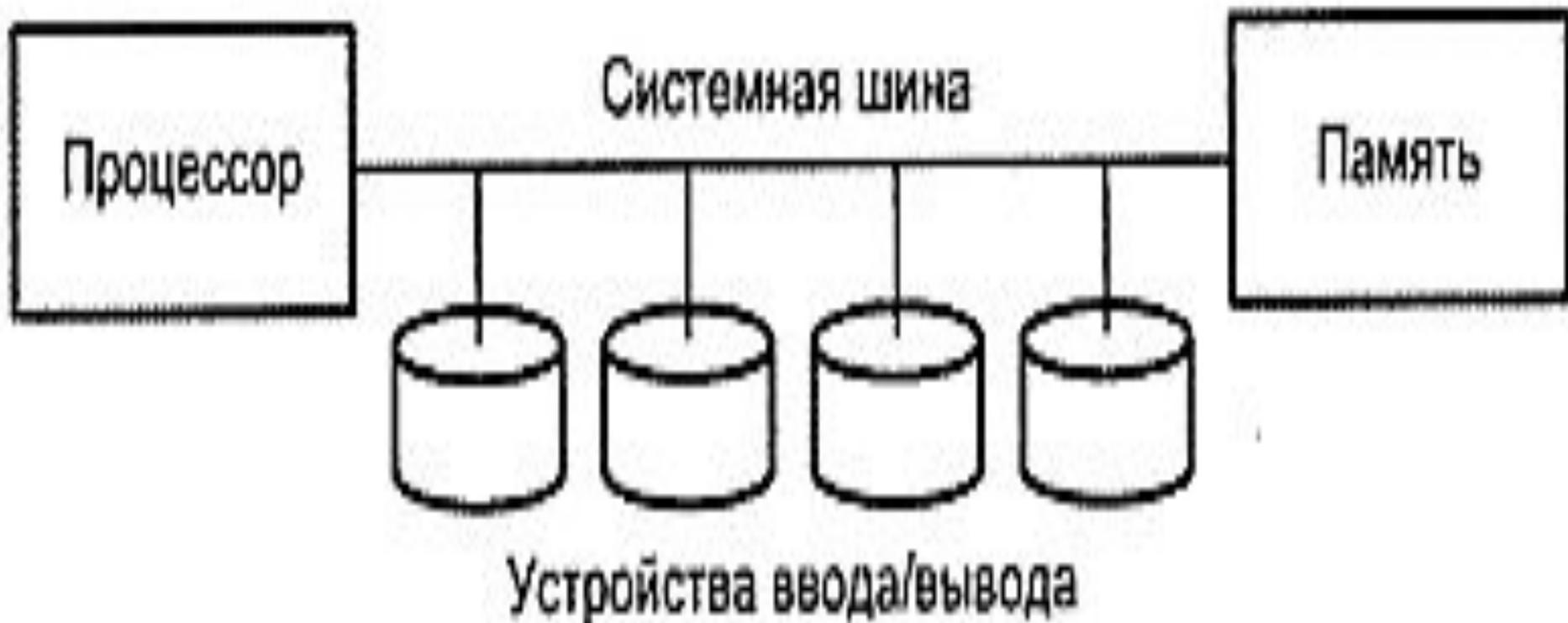
**Рис. 5.5. Структура взаимосвязей с одной шиной**
