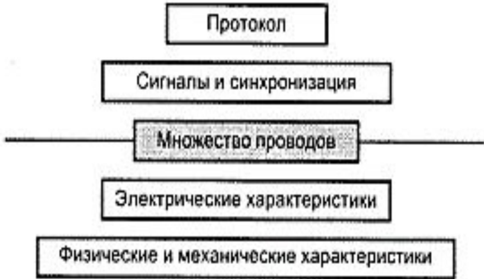
Рис. 5.3. Параметры, характеризующие шину
