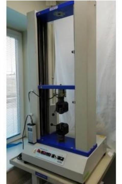
Рисунок 9-Общий вид разрывной машины
