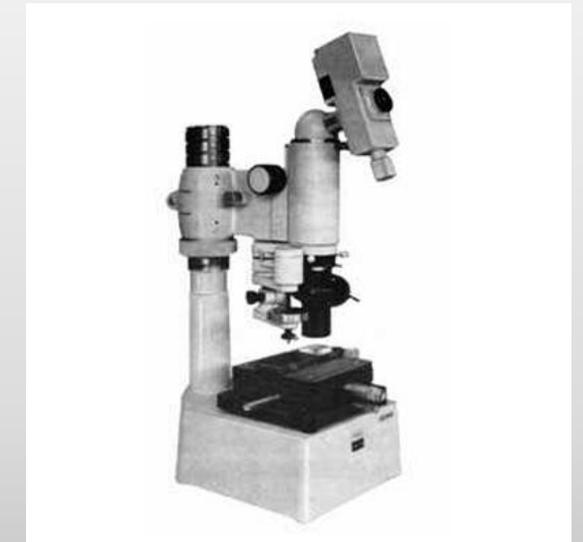
Рисунок 8 – Твердомер ПМТ-3
