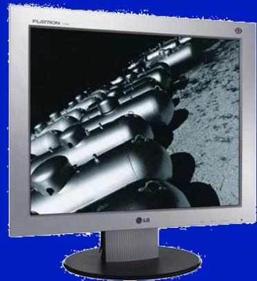
• Жидкокристаллические мониторы сделаны из вещества, находящегося в жидком состоянии, но имеющего при этом некоторые свойства кристаллов. Молекулы жидких кристаллов под воздействием электрического напряжения меняют свойства проходящего сквозь них светового луча, таким образом на мониторе создается изображение.
