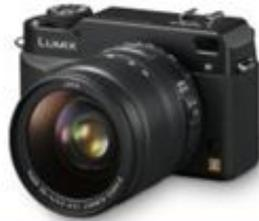
«Просветление оптики» - уменьшение отражения света от поверхности линзы в результате нанесения на нее специальной пленки. Фиолетовый или сиреневый оттенок просветленных объективов.
