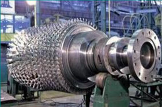
Ротор газовой турбины
