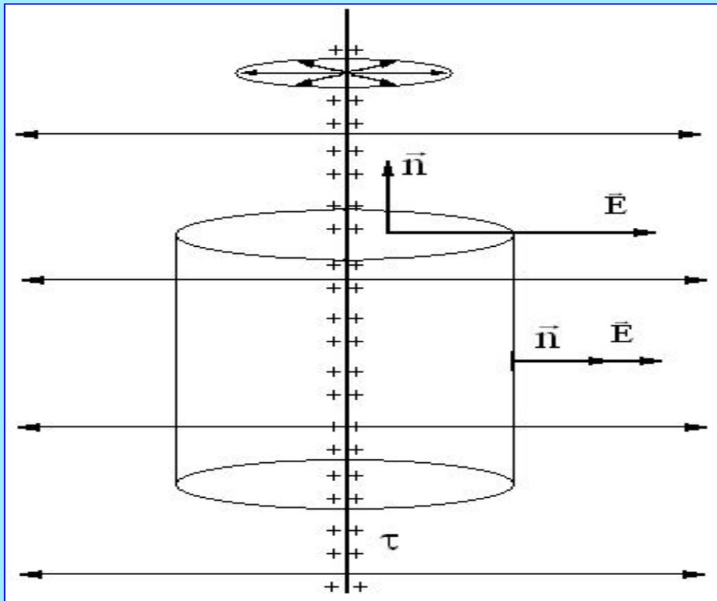
В качестве **гауссовой поверхности** следует выбрать замкнутую **цилиндрическую поверхность** радиусом  **$r$**  и высотой  **$h$** , коаксиальную с нитью.
