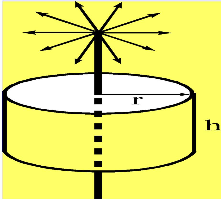
**Поток вектора**  $\vec{E}$  **через эту цилиндрическую поверхность** складывается из потока через боковую поверхность и потоков через два основания цилиндра:
