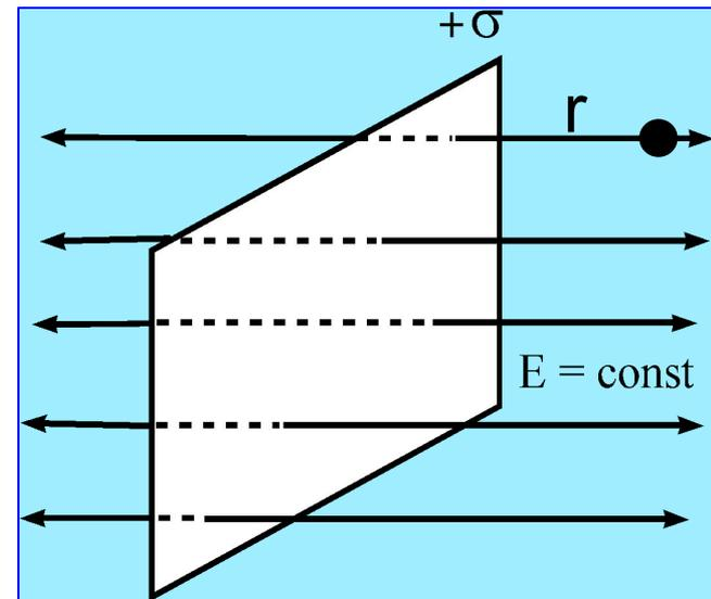
**Силовые линии** в обе стороны **параллельны** между собой и **перпендикулярны** плоскости.
