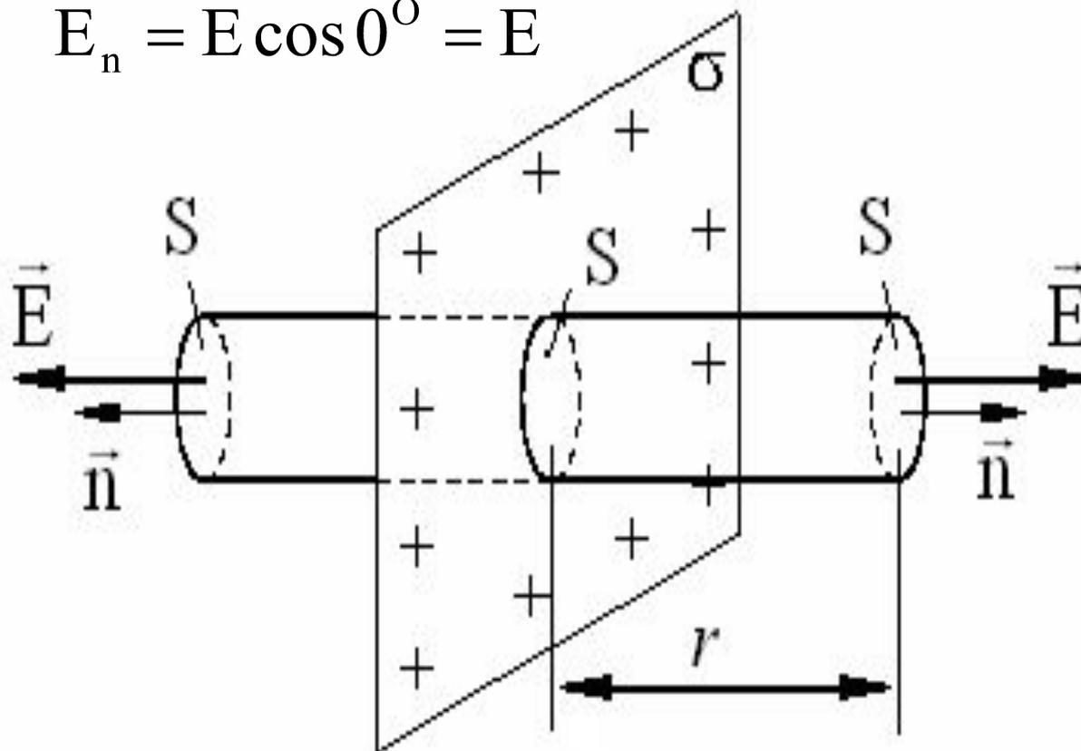
**Полный поток линий**  $\vec{E}$  через эту поверхность складывается из потоков через основания цилиндра и его боковую поверхность:
