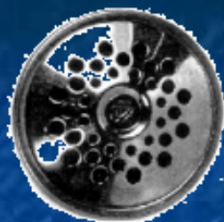
Микрофон обычной телефонной трубки со встроенным передатчиком
