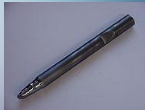
Круглый затравочный кристалл кремния с фрагментом начала оттяжки
