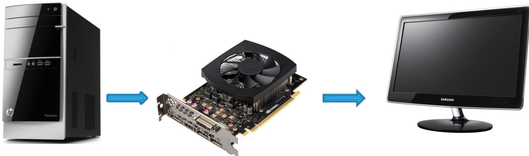
**Видеокарта-устройство, преобразующее графический образ, хранящийся как содержимое памяти компьютера (или самого адаптера), в форму, пригодную для дальнейшего вывода на экран монитора.**
