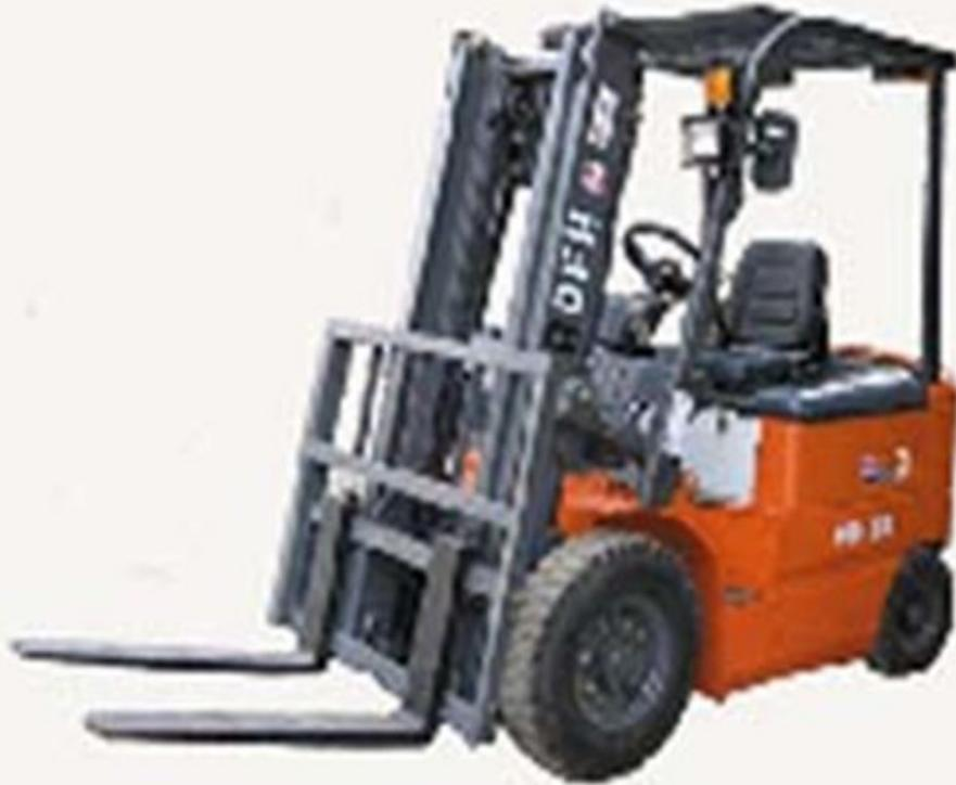
Предназначен для загрузки и выгрузки из сушильной камеры арболитовых блоков и транспортировки их на склад готовой продукции
