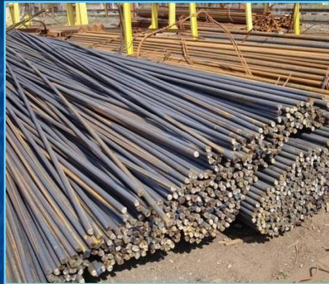
Арматура класса А-1 ГОСТ 5781-82 является горячекатаной гладкой. Стержневую арматуру класса А-1 применяют для обычной (ненапрягаемой) арматуры. В основном арматуру этого класса используют в качестве монтажной, конструктивной и рабочей (поперечной).
