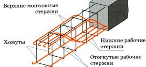
Арматура — вид сортового проката, а именно горячекатаная круглая сталь гладкого и периодического профиля в виде стальных стержней, проволоки, а также изделия из них (сетки, каркасы), которые являются составной частью обычных и предварительно напряженных железобетонных изделий и конструкций.
