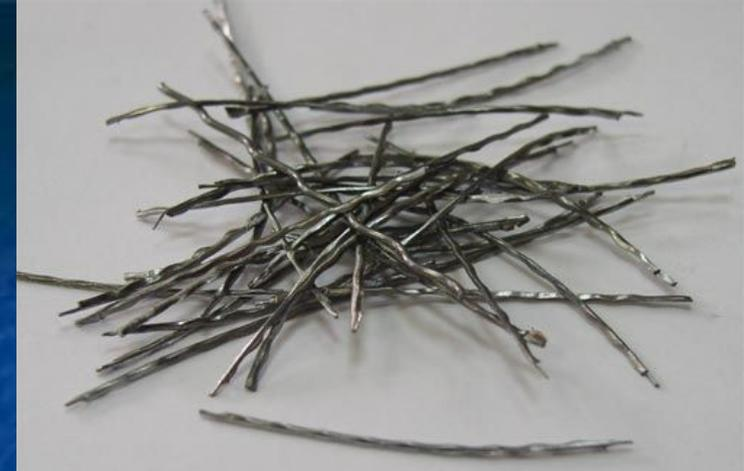
Фибра выпускается длиной  $L = 20, 30$  и  $40$  мм и условным диаметром  $d = 0,6 \dots 1,0$  мм. В соответствии с требованиями заказчика геометрические размеры фибры могут быть иными.
